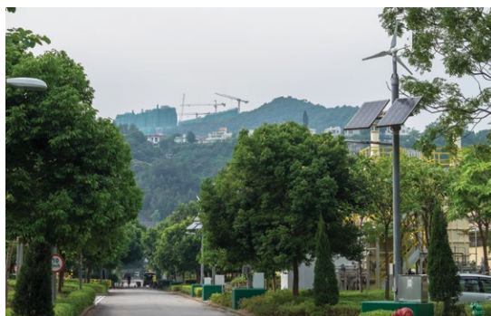
Paneles solares y turbinas eólicas proveen de energía al alumbrado público, Hong Kong, China.
