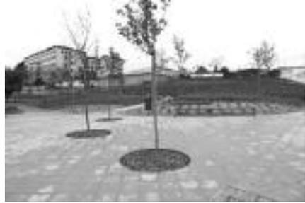
• C/ Valle de Egüés. Cambio de alineación de fachada, definida por parterre con bordillo ligeramente resaltado, dificultando la orientación para la conexión con el ascensor y presentando mobiliario en la alineación de fachada.
